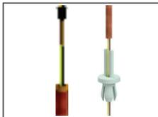
7. Führen Sie die Kabel der LED-Steckdose mit den abisolierten Enden von der nicht lackierten Seite in den Lampenmast ein. Den Steckfuß am lackierten Ende über die Kabel schieben und auf den Lampenmast stecken.
