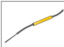
9. Schieben Sie das gelbe Stück Schrumpfschlauch auf das gelbe Kabel.
