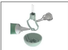
2. Der Lampenschirmhalter wird in den Lampenschirm eingeklebt.
