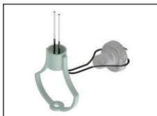
1. Die beiden Kabelenden werden durch den Lampenschirmhalter hindurchgeführt.
