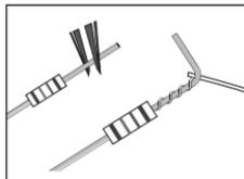
10. Biegen Sie das kurze Ende des Drahtes am beige Widerstand in der Mitte um 90°. Wickeln Sie das blanke Kabelende des gelben Drahtes um das Drahtstück direkt unterhalb des Widerstandes.
