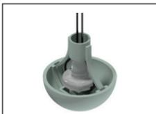
4. Heben Sie die LED leicht an um etwas Sekundenkleber auf den unteren Teil des Lampenschirms aufzutragen. Dazu empfehlen wir einen dünnen Draht oder einen Zahnstocher.
