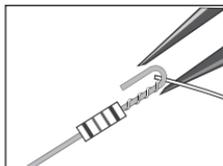
11. Anschließend biegen Sie das senkrecht hochstehende Ende des Widerstandes um.
