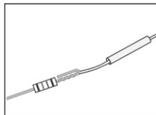
12. Schieben Sie den Schrumpfschlauch auf die zuvor hergestellte Kontaktstelle (Kabel + Widerstand).
