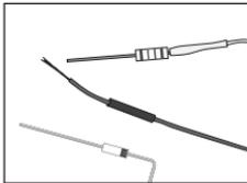
13. Kurz (!) erhitzen, etwa mit einer Heißluftpistole. Schon ist die dauerhafte Verbindung fertig! Vorsicht Verbrennungsgefahr!
