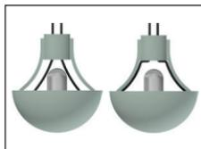
6. Kleben Sie die Kabel mit etwas Klebstoff an den Lampenschirmhalter.
